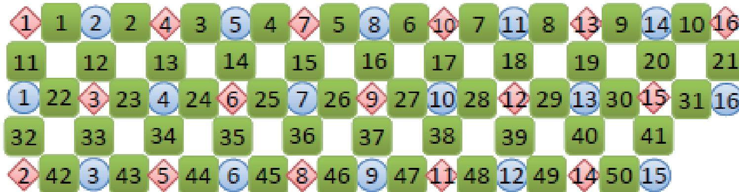
◆ 送光プローブ ○ 受光プローブ ■ 測定チャンネル
