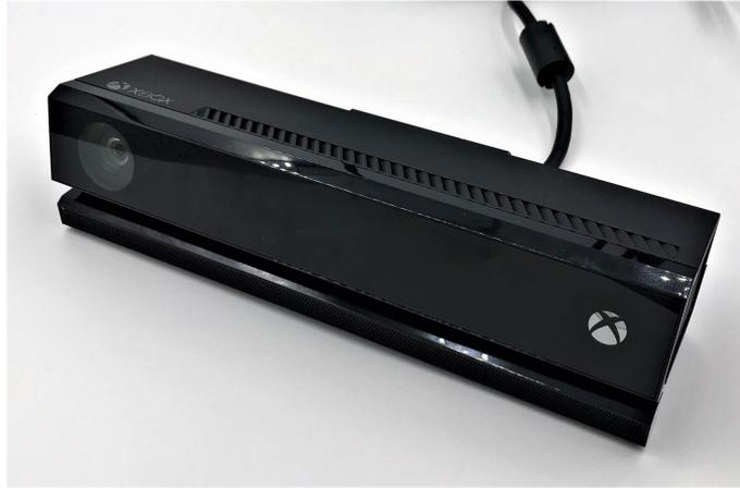
図 4.2: Kinect v2 の外観
