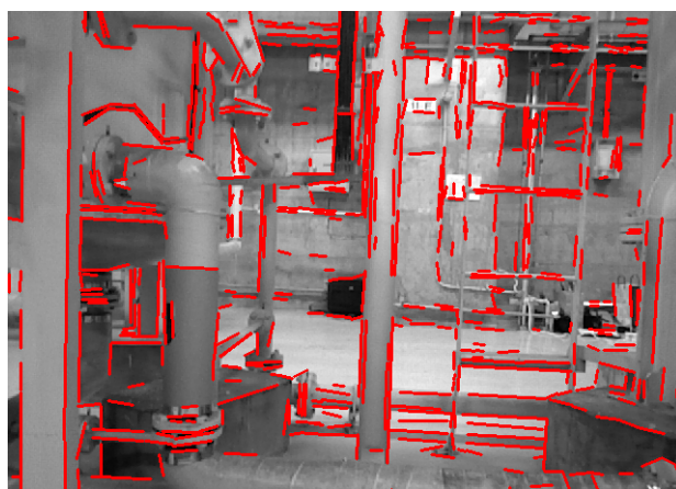
図 3.20: 水平・垂直な線分が数多く認識される場合の例
