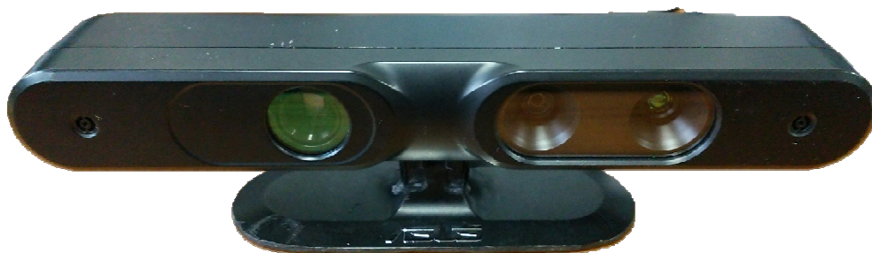
図 4.4: 画像の撮影に使用した Xtion PRO LIVE
