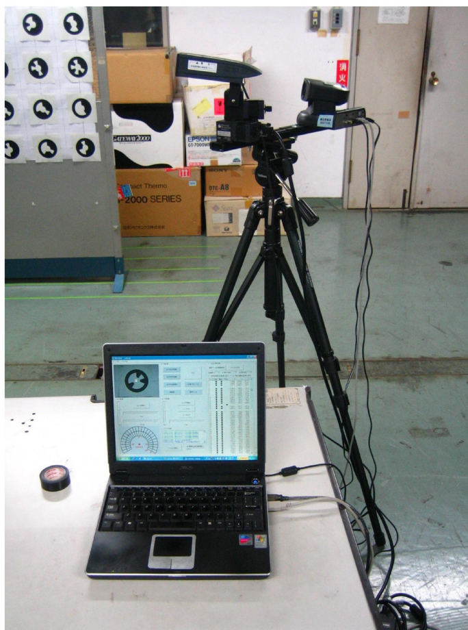
図 4.1: 開発したマーカ自動計測システムの外観
