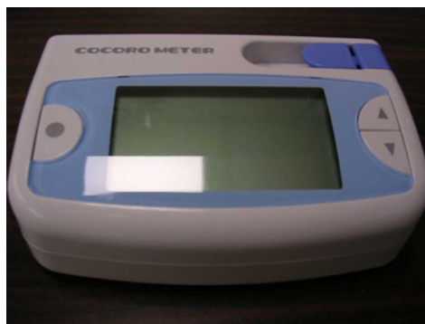
図 4.7: CocoroMeter-唾液からのストレス測定器具
