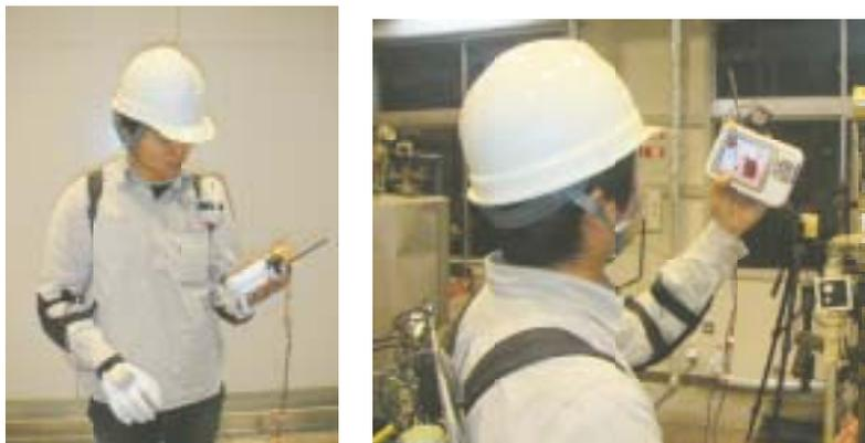
図 4.4: 携帯小型テレビを用いた視線測定システムの装着図
