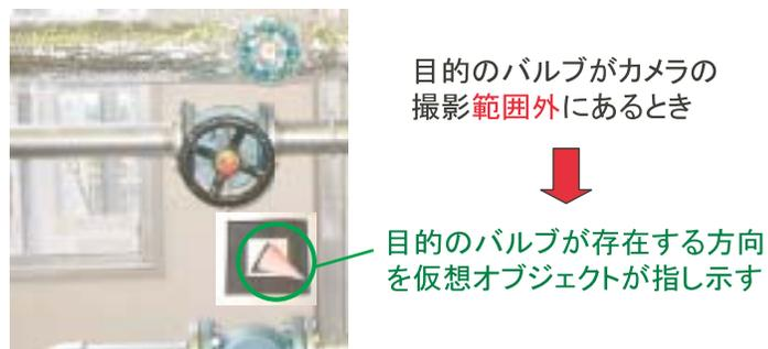
図 3.7: 作業対象バルブがカメラ撮影範囲外にある場合の情報提示
