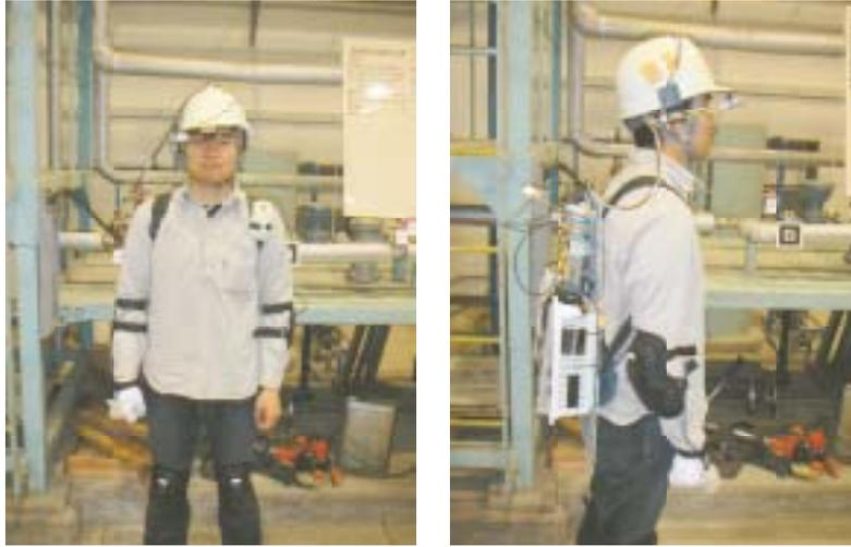
図 4.1: SCOPO を用いた視線測定システムの装着図
