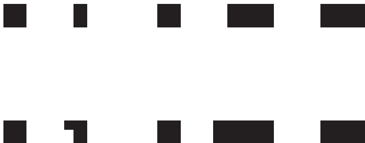
図 5.16: 距離 5.0m、照度均一 1000lux で撮影したバーコードマーカの 2 値画像
