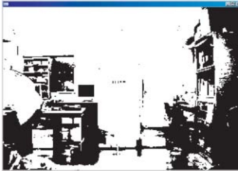
図 5.11: 距離 5.0m、角度 60 °で撮影したバーコードマーカの 2 値画像
