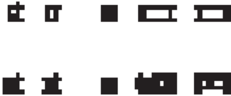
図 5.14: 距離 3.0m、照度均一 1000lux で撮影したバーコードマーカの 2 値画像
