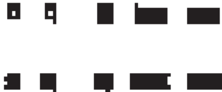
図 5.18: 距離 3.0m、照度 1200 ~ 250lux で撮影したバーコードマーカの 2 値画像
