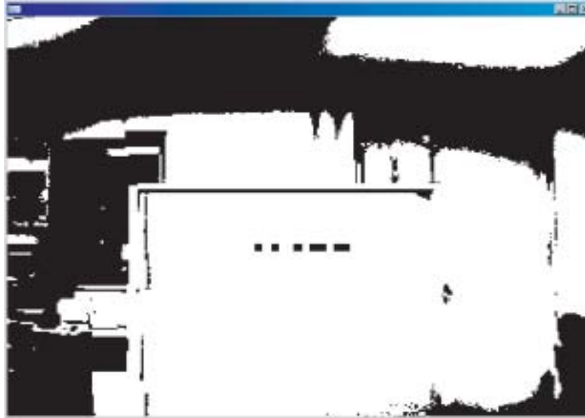
図 5.5: 距離 3.0m、角度 0 °で撮影したバーコードマーカの2値画像
