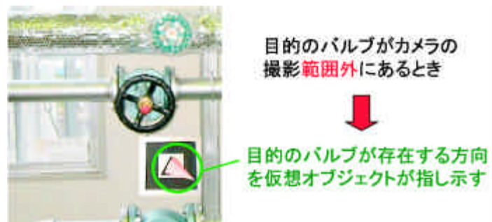
図 3.6: 作業対象バルブがカメラ撮影範囲外にある場合の情報提示
