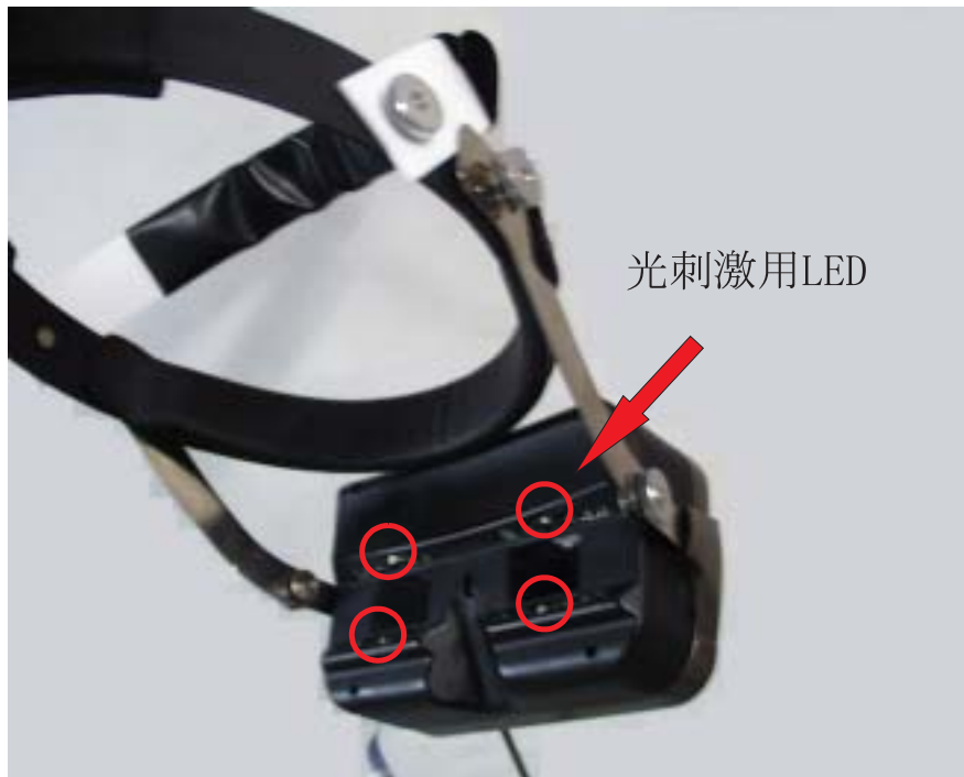
図 3.15: ES-HMD の眼前部に取り付けられた対光反応用 LED
