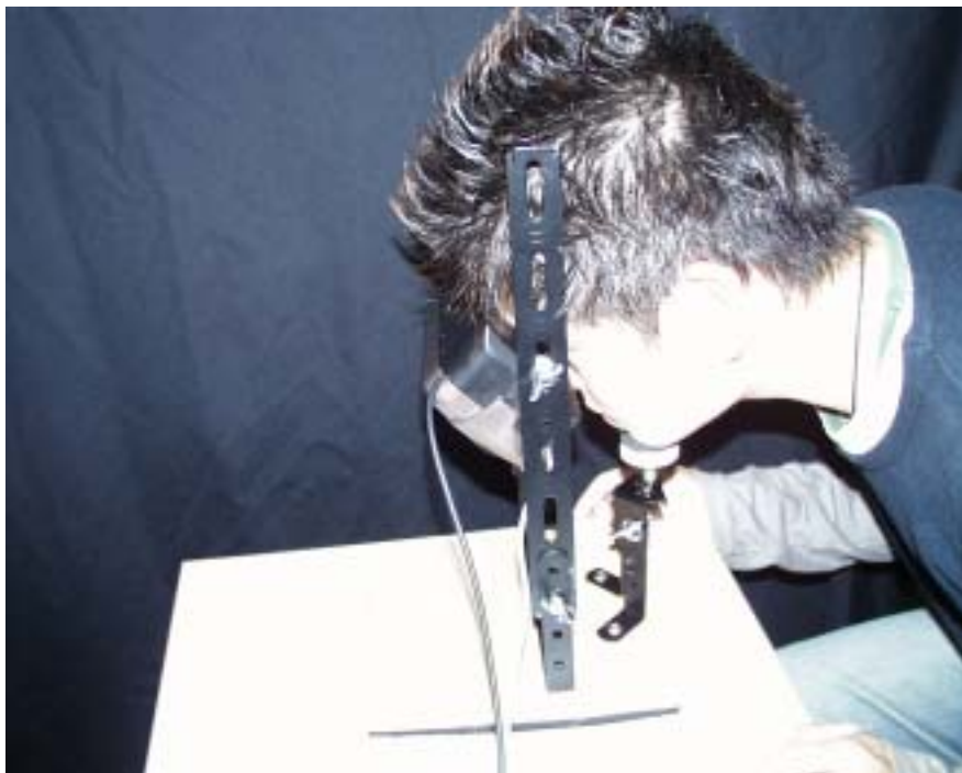
図 3.23: ES-HMD の固定装置 (外観)
