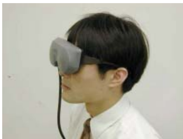
図 3.17: ES-HMD の固定装置 (眼鏡型)
