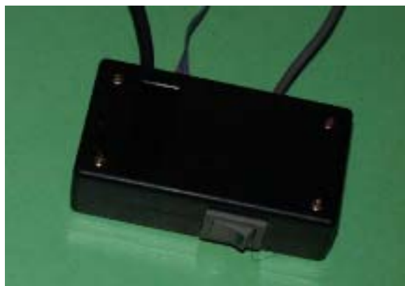
図 3.12: 対光反応用 LED 制御回路ボックス
