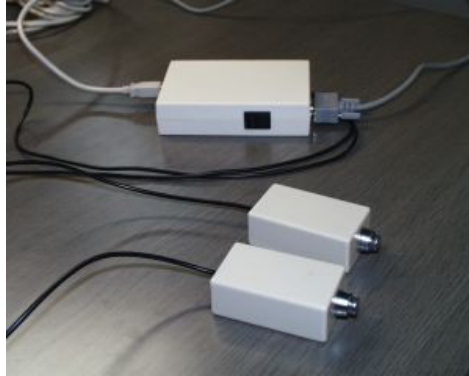
図 4.3: 手の開閉情報を取得するためのボタンデバイス
