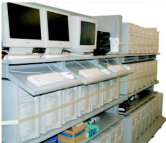
図 2.7: 小規模 PC クラスタ (35 台接続)
