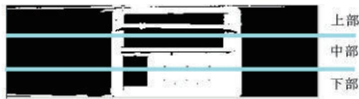
図 4.10: 基板を縦方向に3等分した例
