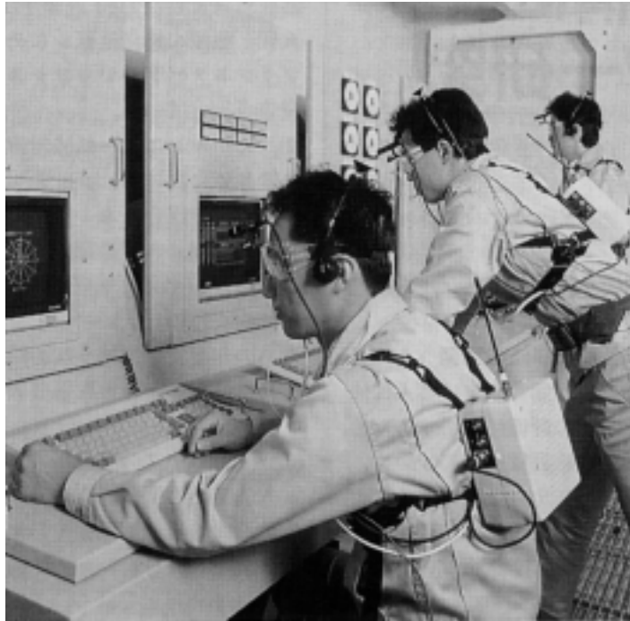
図 2.4: 運転監視作業における視点動作の計測実験の様子
